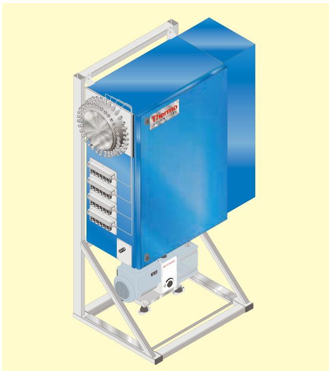
图6 在线质谱仪配置60个取样口和24个标定口
